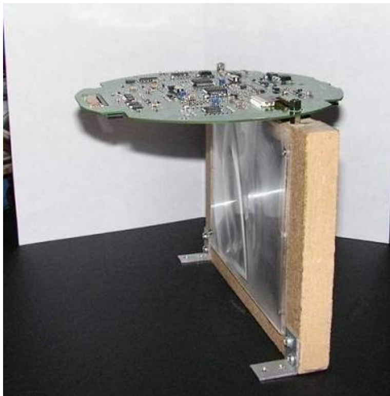
Ici la Fresnel est placée devant la dalle LCD
