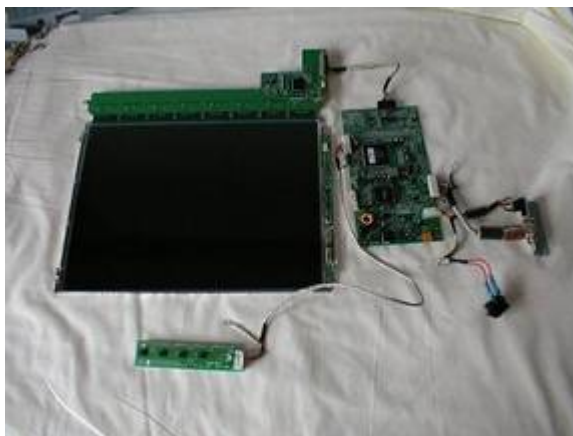
Après un démontage minutieux, voici la dalle LCD du TFT, la lumière pourra la traverser.
