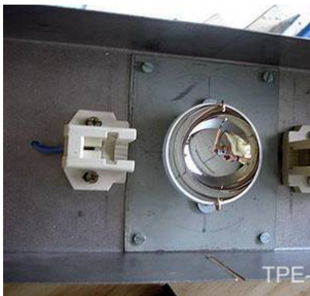
Le réflecteur à placer derrière l'ampoule
